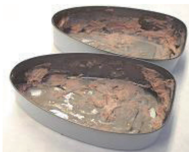
写真1 内容物取り出し後の缶内面の外観写真
